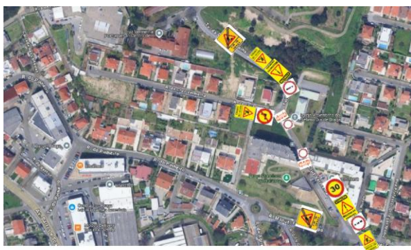
Figura 20: Sinalização temporária, 1ª fase
