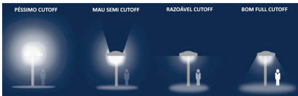
Figura 34 - Tipos de Controlo Rácio de Saída do Fluxo Luminoso Ascendente (ULOR) [17]
