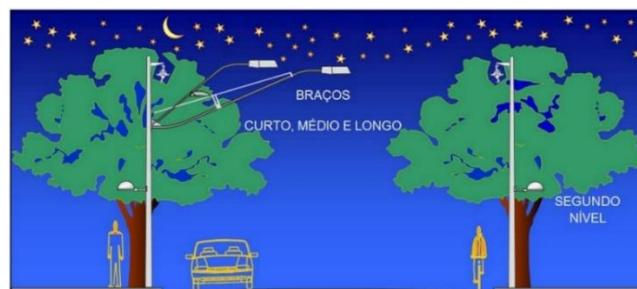
**Figura 39** – Soluções para Interferências da Arborização com a Iluminação Pública [33]
