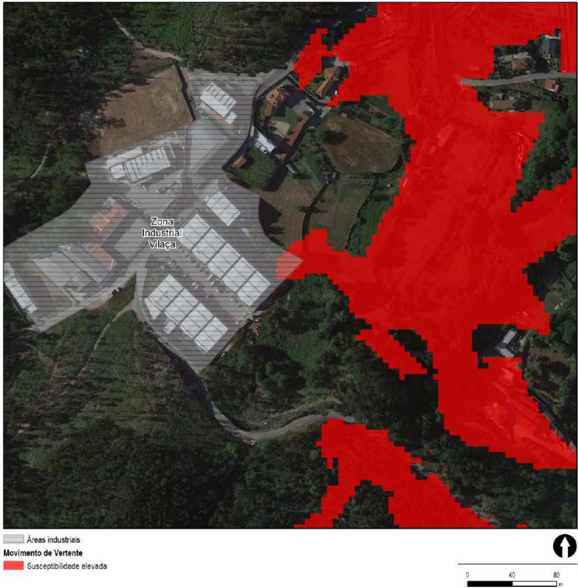
Figura 7.12. Detalhe das zonas industriais mais suscetíveis a movimentos de vertente – Zona Industrial Vilaça
