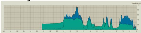
Analisando o resistograma, obtido a cerca de 50cm verificamos presença de cavidades internas no tronco. Aconselhamos o seu ABATE pelo facto de se apresentar em Dieback, aliado à presença de cavidades internas a nível do tronco e ser um estacionamento muito frequentado.
