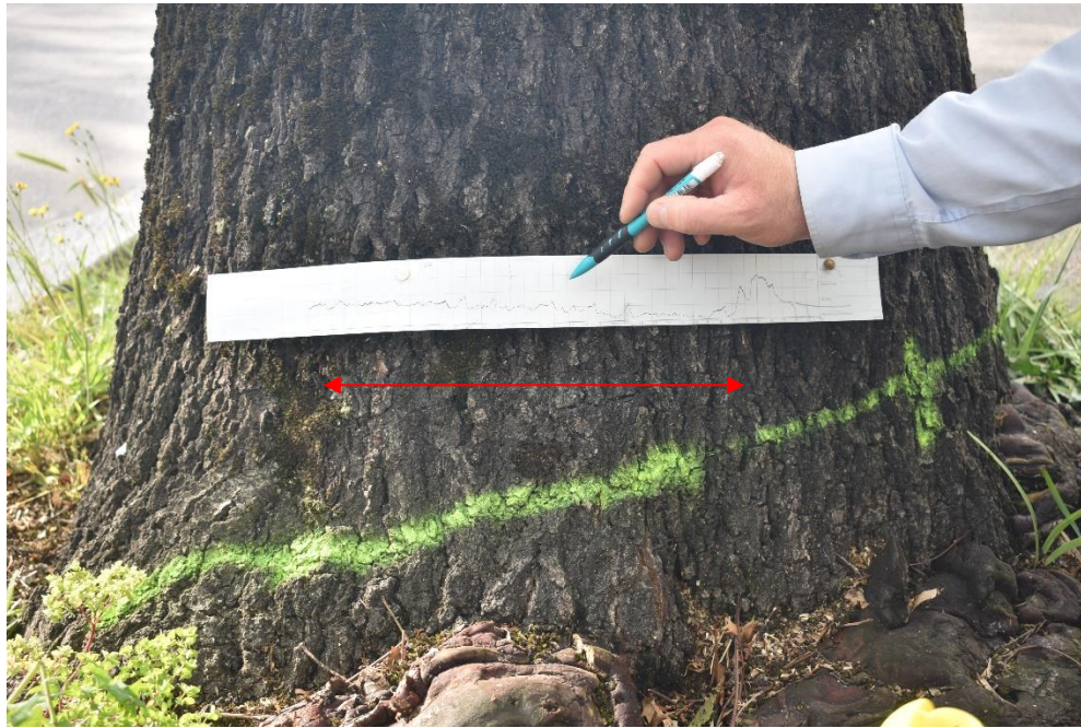
Figura 2.4 – Representação no gráfico do resistógrafo da área afetada na árvore 4 por Ganoderma lucidum na zona do colo.
