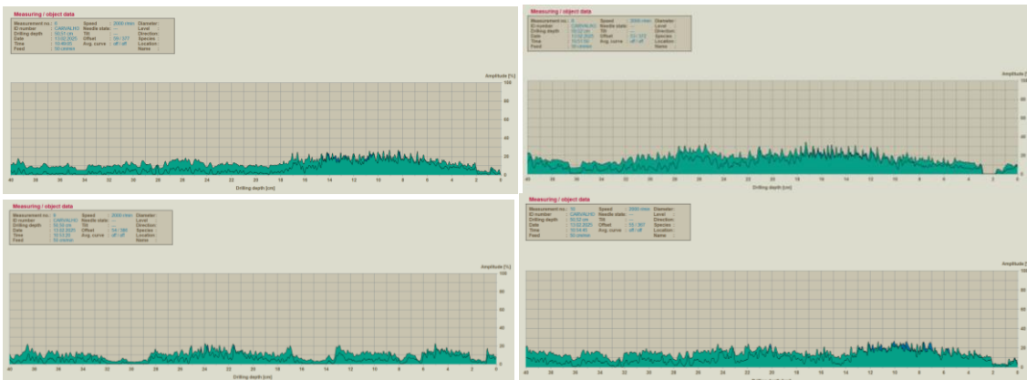
Figura 8– Resistogramas efetuados a 1m no tronco do Carvalho ( Quercus sp.), na Av. Dr. Francisco Pires Gonçalves, em Braga.
